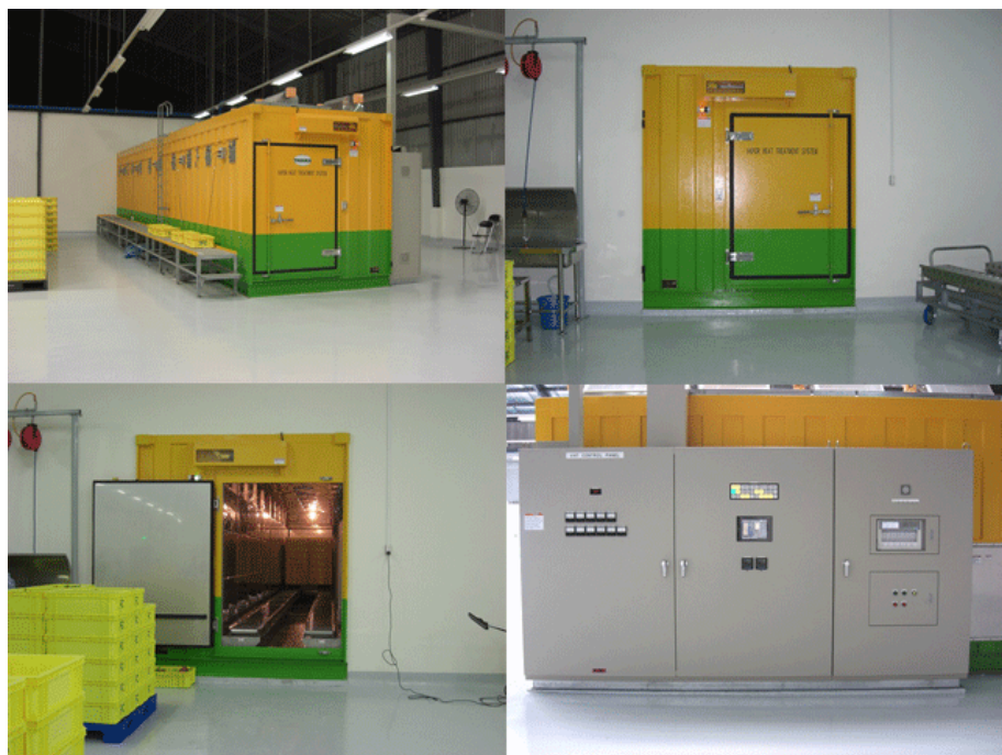
Hình 5. Hệ thống thiết bị xử lý trái cây hơi nước nóng
